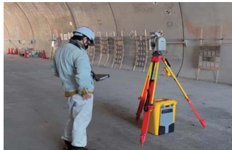
3次元点群データの計測、計測状況の監視
