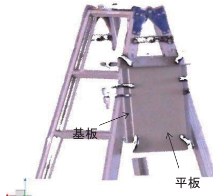
台座に変位を模擬する平板を取付けた状態(変位あり)
