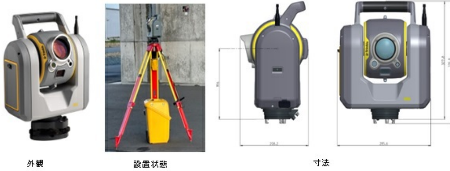
計測装置(3次元レーザーキャナー機能を備えたトータルステーションTrimble SX10)
